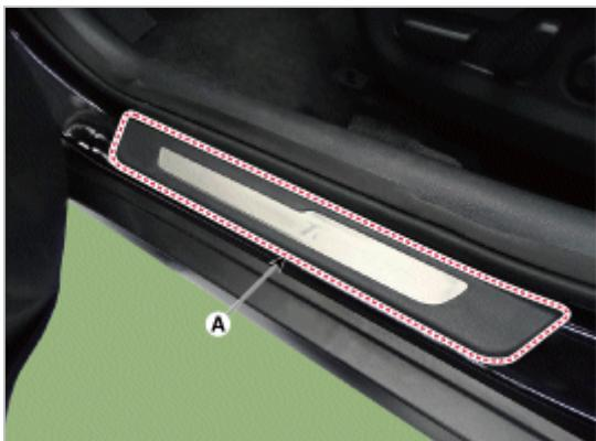
2. 使用螺丝刀或拆卸工具拆卸后车门踏步装饰板 (A)。
